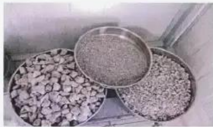
Πηχυσμένη πραυστή αδρανή (άμμος - γορμπήλι - χαλίκι) στο Εργαστήριο, έτοιμα για υπομολόγηση
