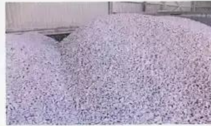
Πραυστό χαλίκι (12-31mm) στη καρούτα στο Εργαστήριο Σκυρ/τος
